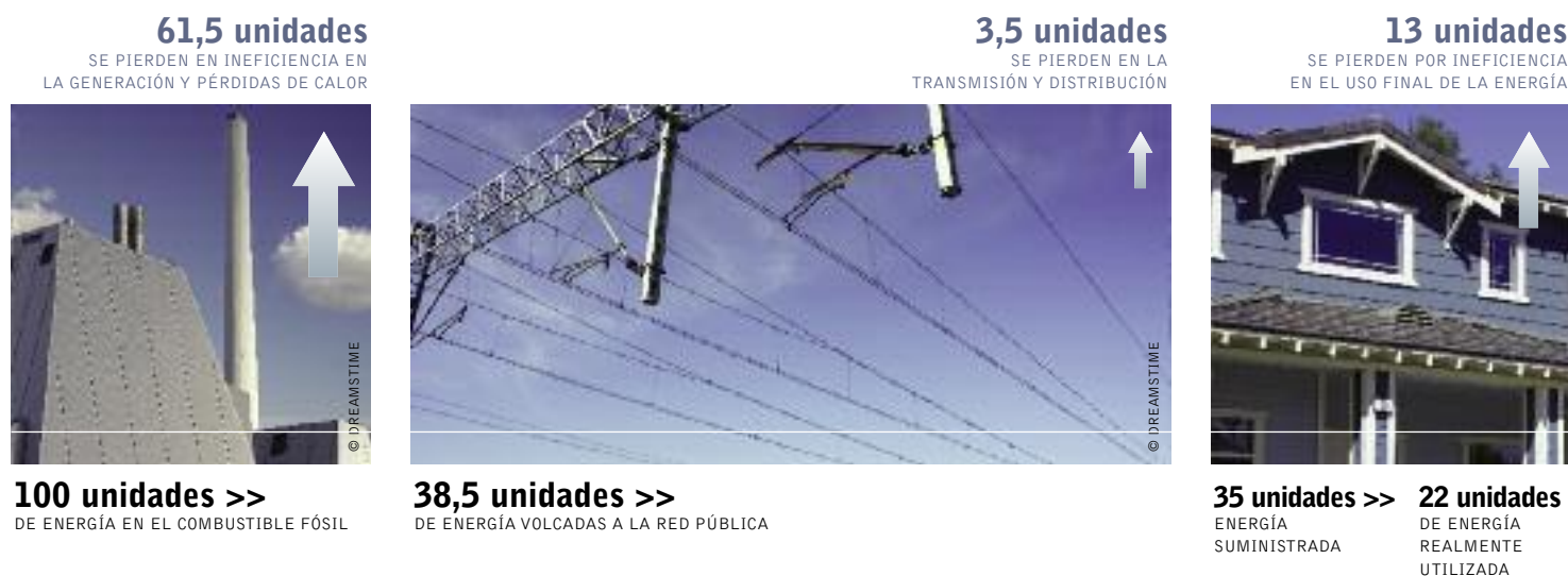
figura 4.1: el sistema centralizado desperdicia más de 2 tercios de la energía
