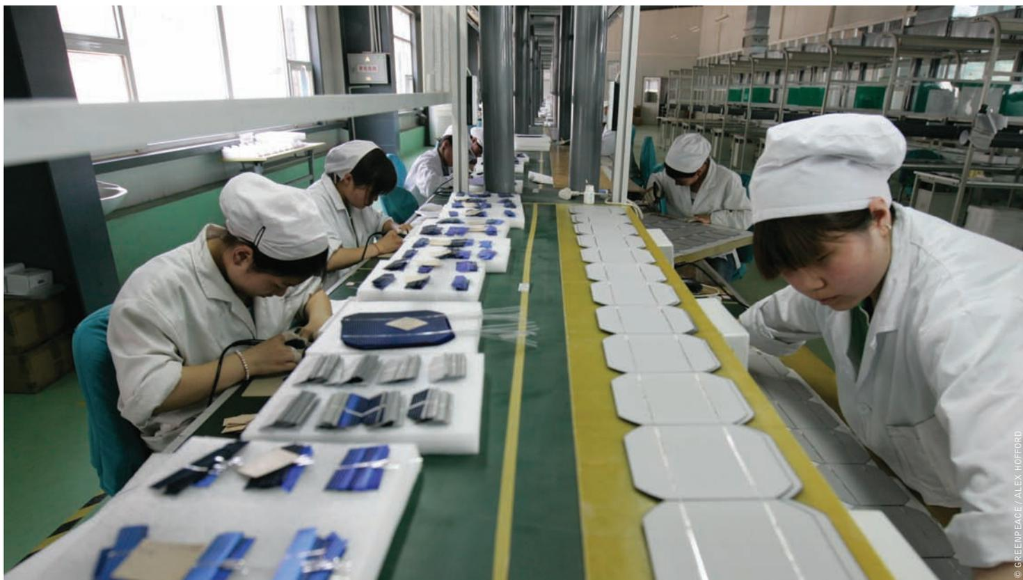
imagen CELDAS FOTOVOLTAICAS (FV) SON ENSAMBLADAS POR LOS TRABAJADORES DE UNA FÁBRICA PROPIEDAD DEL GRUPO HIMIN, EL MAYOR FABRICANTE DE CALENTADORES TERMOSOLARES DE AGUA A NIVEL GLOBAL. LA CIUDAD DE DEZHOU ES LIDER EN LA ADOPCIÓN DE ENERGÍA SOLAR Y SE LE CONOCE COMO EL VALLE SOLAR DE CHINA.
