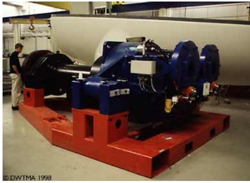
Figura 2.12 a) Caja de engranes con un eje de baja velocidad y dos ejes de alta velocidad, b) Caja de engranes simple [121][126].
