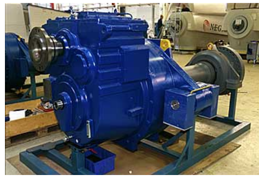
Figura 2.12 a) Caja de engranes con un eje de baja velocidad y dos ejes de alta velocidad, b) Caja de engranes simple [121][126].
