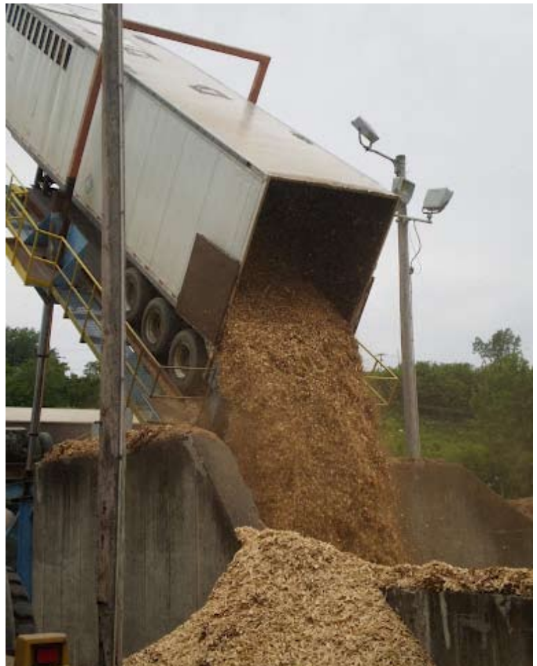
Chips de madera siendo descargados en un incinerador de biomasa. Autor: Josh Schlossberg. The Biomass Monitor y Energy Justice Network
